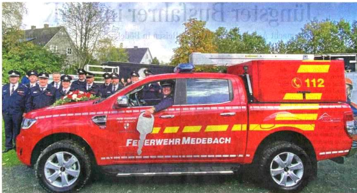
Neue Wege in der Feuerwehr-Arbeit geht die Löschgruppe Küstelberg mit ihrem geländegängigen Einsatzfahrzeug, das mit zwei verschiedenen Wechselaufbauten für Brandbekämpfung oder technische Hilfeleistung ausgestattet werden kann.
